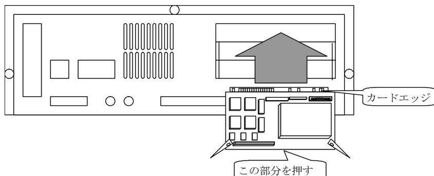
部品面を上にして、インターフェイスボードをパソコン本体の拡張スロットのガードレールの溝に合わせて、ゆっくりと差し込みます。
